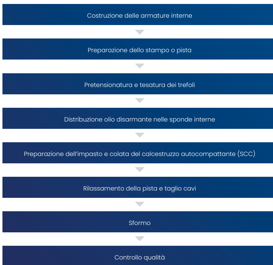
Figura 3: Schema ciclo produttivo trave prefabbricata
